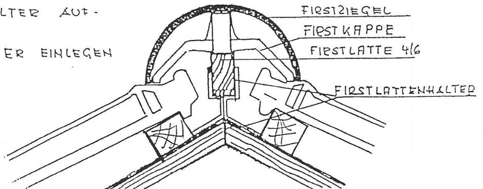
JETZT DIE 1 METER LANGEN KUNSTSTOFF - FIRSTKAPPEN AUFSETZEN UND FESTSCHRAUBEN. MIT FIRSTANFANG - UND EHDSCHLEIBE ABDECKEN. JETZT DIE ERSTE LÜFTET FIRSTZIEGEL AUFDRÜCKEN UND MIT DEN ALUKLAMMERN FESTKLEMMEN, DANN DIE NÄCHSTE FIRSTZIEGEL AUFSETZEN.
