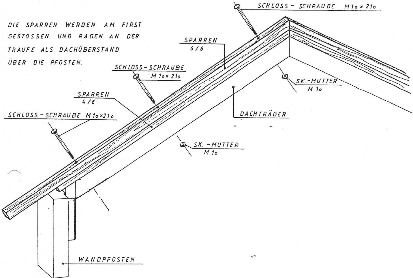
AM DACHTRÄGER UND FRONTRÄGER WERDEN DIE DOPPELSPARREN MIT JE 3 SCHLOSS-SCHRAUBEN M 10 x 210 ANGESCHRAUBT. AUF DIE RÜCKTRÄGER MIT SCHLOSS-SCHRAUBE M 10 x 130.
