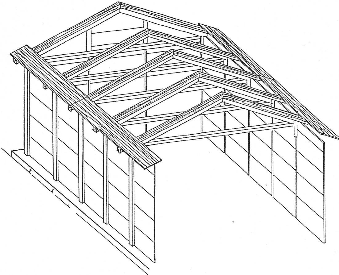
DIE TRAUFBREITE (NUT + FEDERHOLZ) WERDEN VON UNTEN NACH OBEN VERLEGT. SIE SIND AUF GENAUE LÄNGE GESCHNITTEN, SO DASS DER STOSS IMMER IN DER MITTE DER SPARREN LIEGEN MUSS. SIE ERHALTEN SO EINEN GLEICHMÄSSIGEN ÜBERSTAND AN DEN BEIDEN GIEBELSEITEN.
